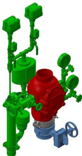
Figur 1: Kontrollventilsett for våtanlegg utført etter NS-EN 12845. (Bilde fra Victaulic)
